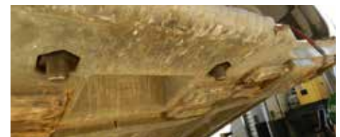
Bloc Dutchman avec les deux boulons maintenant en place l'insertion d'Astralloy. Le «verrou» Dutchman glisse à travers l'orifice et s'accroche sur notre insertion AV.
